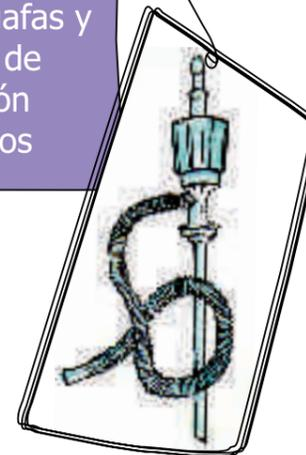
Realiza un mantenimiento apropiado de la máquina de limpieza en seco: extrae los residuos del destilador en frío al inicio de la jornada; limpia diariamente el cazabotones y el filtro de pelusa y guarda los residuos en un recipiente herméticamente cerrado. Para todo esto, usa EPI's y ventila la zona
